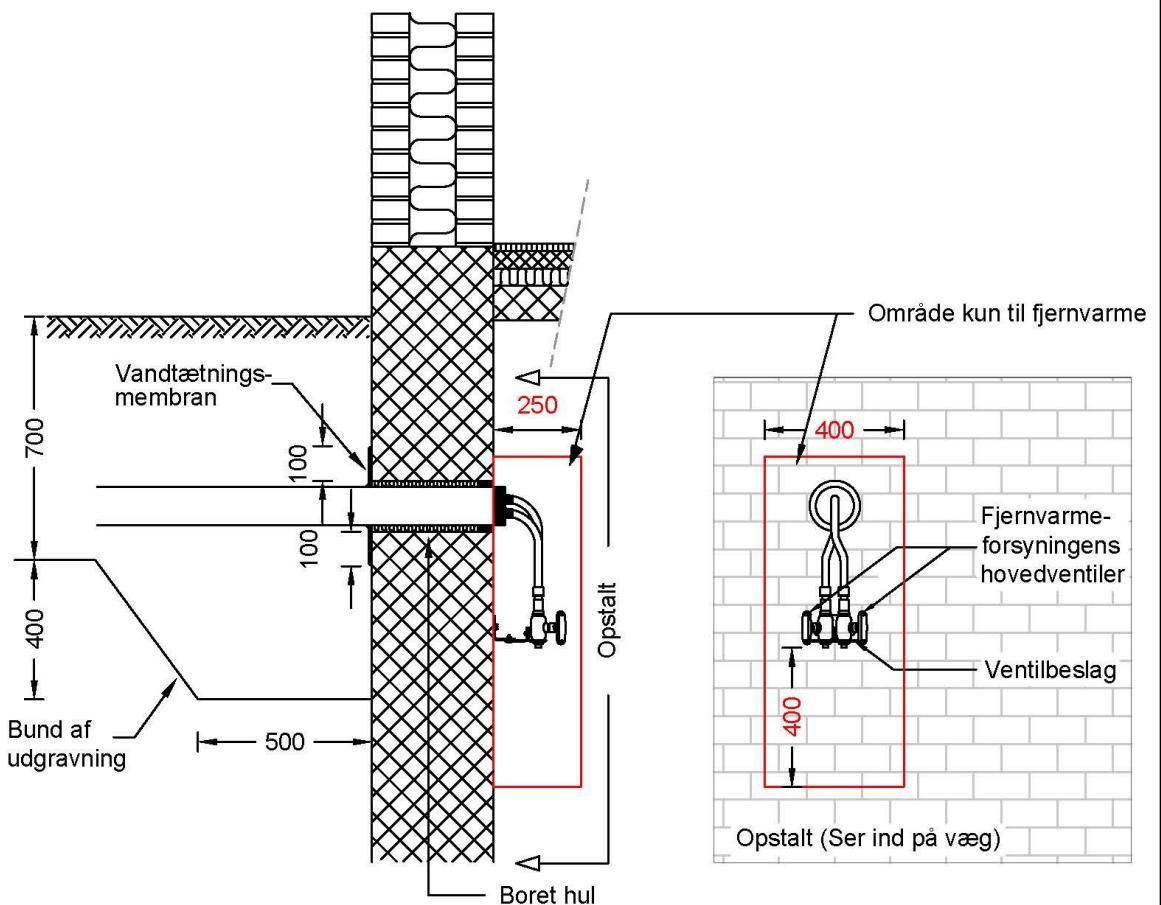
For stik  $\geq$  33-33/180 mm monteres Linkseal indvendigt i de tilfælde, hvor der er vandtryk på kældervæg.
