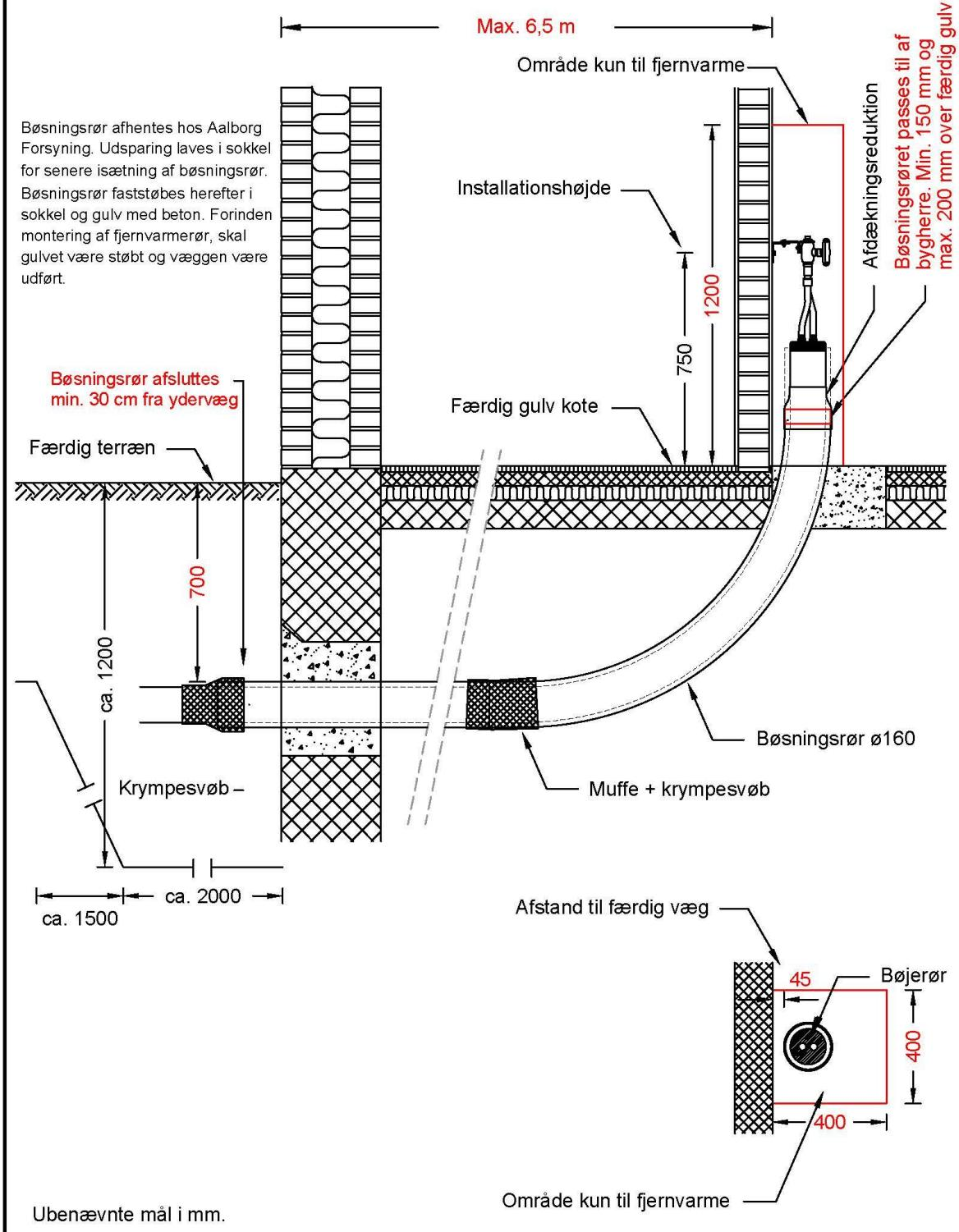
**Figur 5. Princip for husindføring - over terræn**
