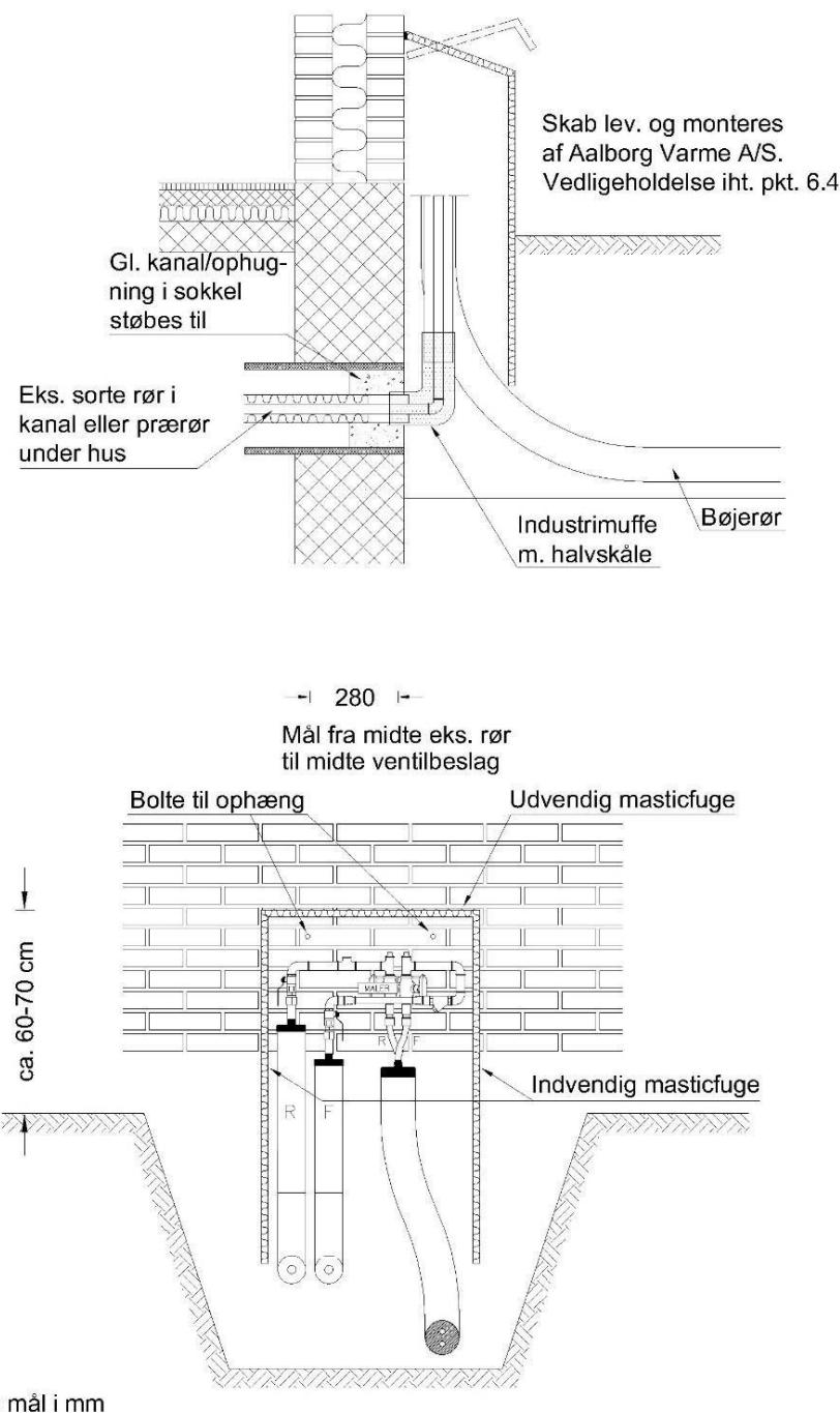
**Figur 8. Større rør i sokkel**
